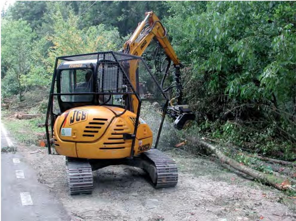
Figura 9 - Allestimento con miniprocessore (Foto di Leonardo Rescic).
