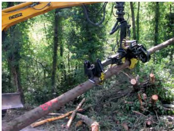
Figura 15 - Particolare del miniprocessore (Foto di Leonardo Rescic).
