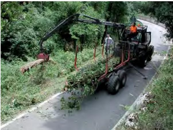
Figura 16 - Movimentazione dei tronchi con trattore e rimorchio munito di gru e pinza (Foto di Leonardo Rescic).
